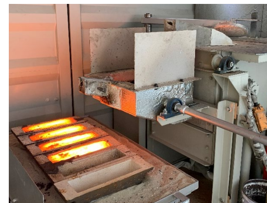
モバイル金属溶融設備によるインゴット製作検証
