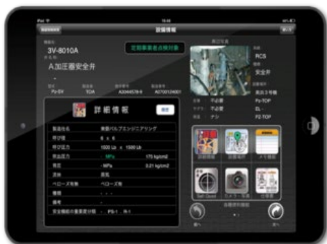
Omo10-VALVE (バルブ点検支援タブレット)
